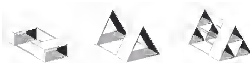
Figura 10. Evolución del modelo de cometa de Lawrence Hargrave. Ilustraciones realizadas por el autor a partir de las descripciones en «The Tetrahedral Principle In Kite Structure», (Bell, 1903).
