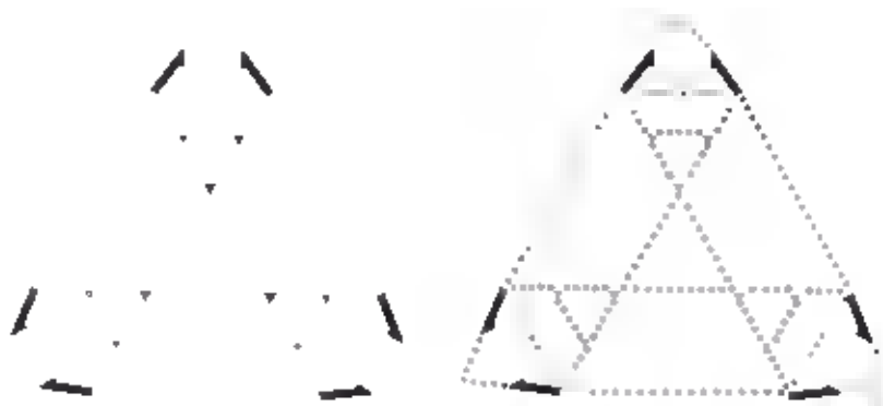
Figura 73. Esquema estructural del Commerzbank: principales puntos de apoyo y líneas directrices. Esquema realizado por el autor.
